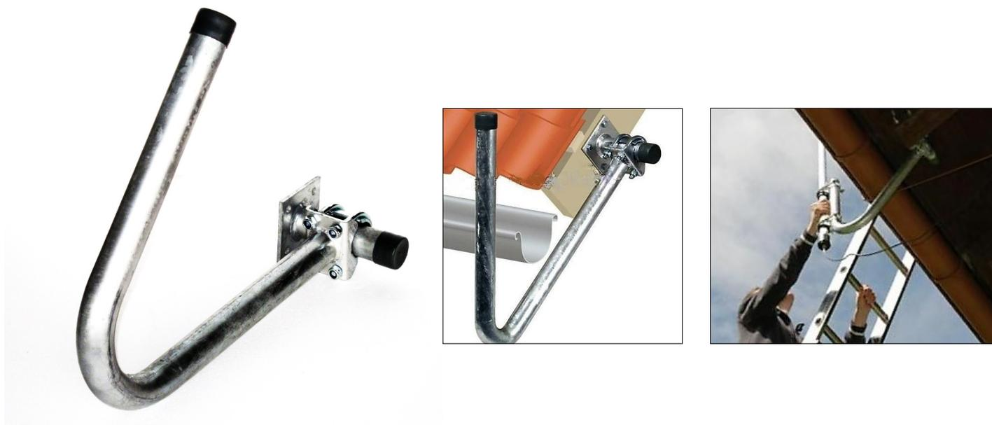
Der **Dachüberstands-Halter** wird seitlich an den im Traufbereich überstehenden Dachsparren befestigt (Befestigungsmaterial ist nicht im Lieferumfang enthalten). Der Mast ist so geformt, dass die SAT-Schüssel vor der Dachrinne befestigt werden kann.
